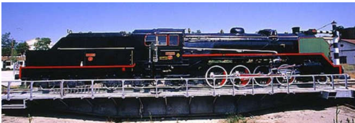
Locomotora tipo Mikado , en el puente giratorio de Arcos de Jalón.
