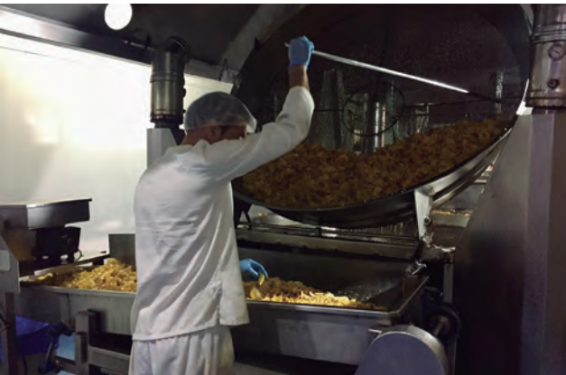
Una de las grandes sartenes, de 800 litros, que se utilizan para freír las patatas. El proceso es muy artesanal y delicado para conseguir la mejor fritura.
